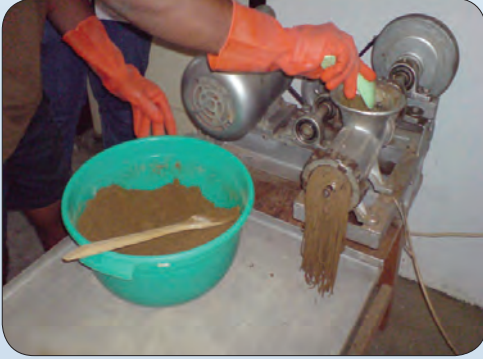
ث: وضع خليط العليقة في جهاز الفرغ.
